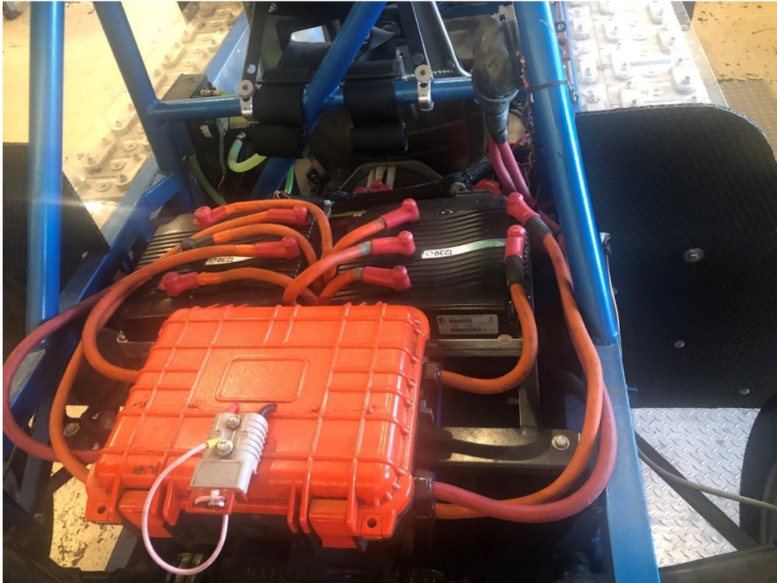
**ADVERTENCIA: NO conecte el vehículo hasta que se hayan desactivado los sistemas eléctricos LV (12v) y HV. Cortar el vehículo antes de desconectar y aislar las fuentes de energía eléctrica de 12v y HV puede causar una descarga eléctrica.**
